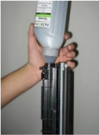
Рисунок 1.17- Заправляем крышку
