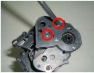
Рисунок 1.20-Устанавливаем боковую крышку
