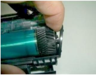
Рисунок 1.8- Вытаскивание фотобарабана
