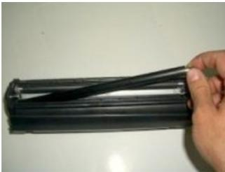
Рисунок 1.9- Извлечение коротрон
