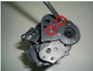
Рисунок 1.7- Снятие крышки
