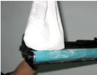
Рисунок 1.15- Устанавливаем фотобарабан
