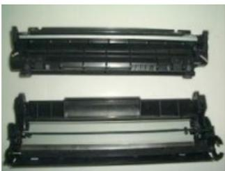
Рисунок 1.13- Разборка картриджа
