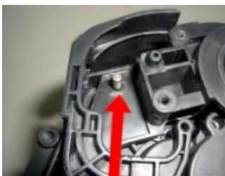
Рисунок 1.19- Устанавливаем боковую крышку.
