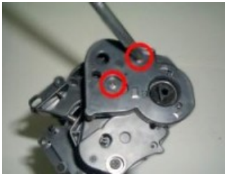
Рисунок 1.20-Устанавливаем боковую крышку
