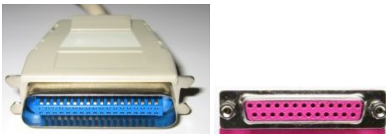
Рисунок 1.2 – Разъем интерфейса Centronics на кабеле и материнской плате
