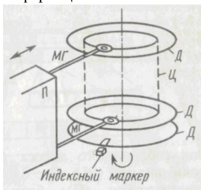
Рисунок 3.1 – Конструкция и логическая организация винчестера
