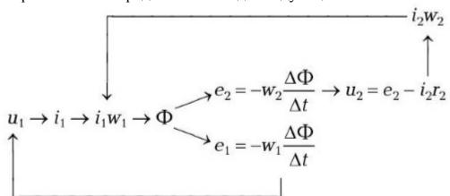
Магнитный поток в сердечнике при работе трансформатора под нагрузкой определяется результирующей намагничивающих сил первичной и вторичной обмоток, равной  $i_1w_1-i_2w_2$ , а на холостом ходу — только намагничивающей силой первичной обмотки  $i_0w_1$ , где  $i_0$  — ток холостого хода трансформатора
