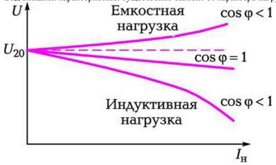
При чисто активной нагрузке (cosφ =1 — лампа накаливания, нагреватель) внешняя характеристика слегка падающая, что объясняется увеличением падения напряжения на активном сопротивлении обмоток с ростом тока нагрузки. В случае индуктивной нагрузки (cosφ < 1 — дроссель, сварочный трансформатор, электрический двигатель) напряжение при увеличении тока может падать довольно
