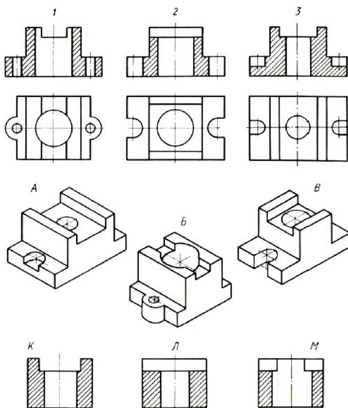
3. Изображение детали содержит фронтальный и профильный разрезы (штриховка на них не показана), вид сверху и аксонометрическое изображение. Дополните изображения разрезов штриховкой.
