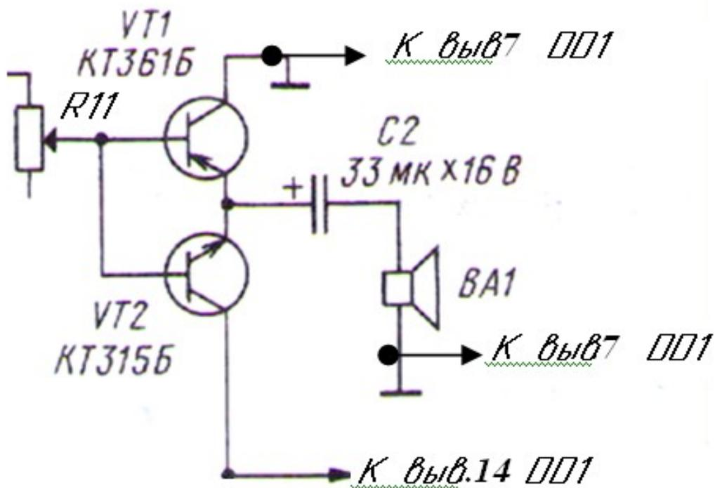
Доработка схемы «Имитатор шума прибора»
