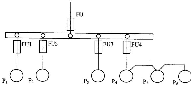
Рисунок 33 - Схема распределительной сети
