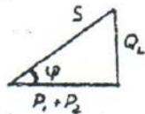
Рисунок 21 - Векторная диаграмма, треугольник сопротивлений и треугольник мощностей
