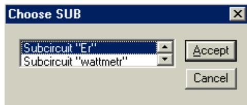
В этом списке выбираем необходимый компонент, например **Subcircuit “E<sub>r</sub>”**, по команде **Accept** получаем специальную цепь
