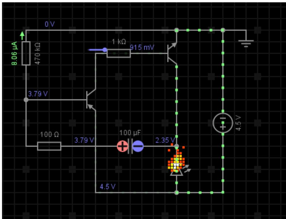
Поначалу покажет, что светодиод сгоревший и схема типа не рабочая. Надо просто немного подождать, чтобы схема вошла в устойчивое состояние. Все таки это не реальные радиоэлементы, а их математические модели.
