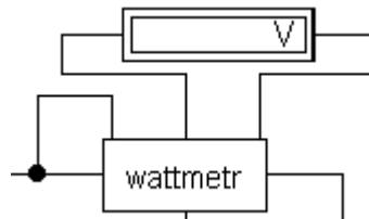
которая встраивается специальным образом в схему для измерений. Так как у ваттметра нет собственного индикатора показаний, то используется вольтметр, который присоединяется к дополнительным выводам прибора. Показания в вольтах в этом случае надо считать как ватты.
