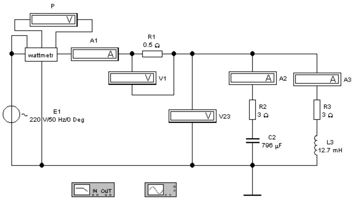
В этой схеме возможно применение графопостроителя (**Bode Plotter**) для измерения фазового сдвига и осциллографа (**Oscilloscope**) для получения формы кривой напряжения
