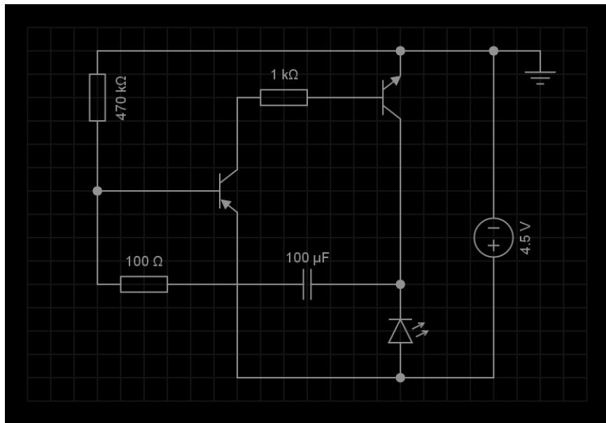
Вот так примерно выглядит уже сэмюлированная схема:
