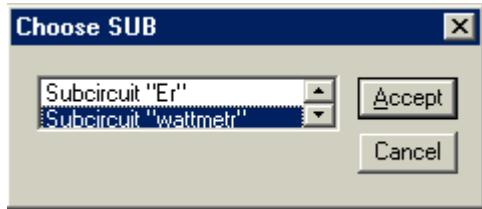
В этом списке выбираем необходимый компонент, например **Subcircuit "wattnetr"**, нажимаем кнопку **Accept** и получаем специальную цепь,
