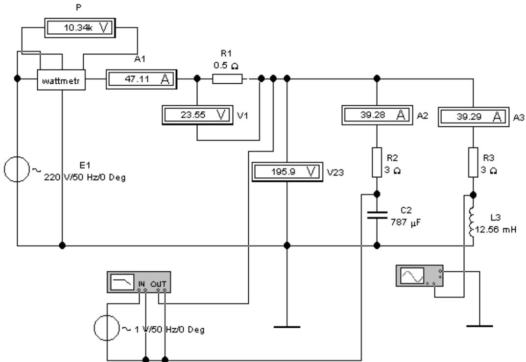
При этом **Bode Plotter** показывает фазовый сдвиг  $\varphi = 53,46^\circ$  между напряжением  $U_{23}$  и током  $I_2$ ,
