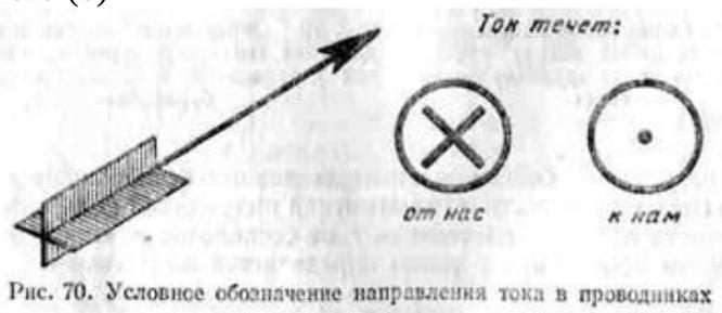
Рис. 70. Условное обозначение направления тока в проводниках
