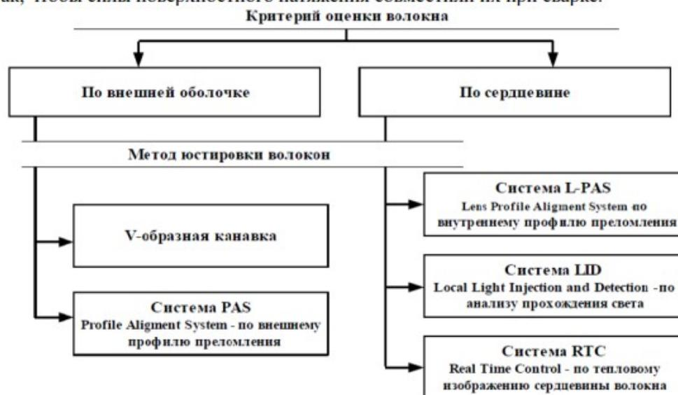
Рисунок 1 – Классификация методов юстировки ОВ
