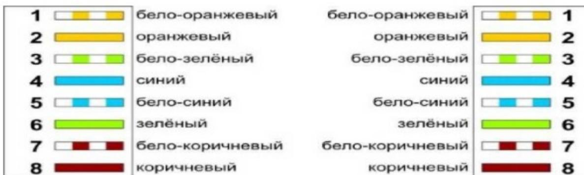
Рис. 3. Схемы обжимки кабеля: а - прямой кабель
