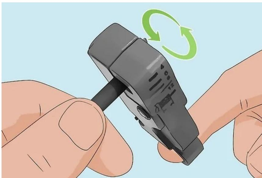
**4. После завершения зачистки уберите стриппер.** Стриппер делает 2 надреза одновременно. Аккуратно снимите пальцами материал с концов кабеля. Таким образом обнажите центральный проводник каждого кабеля.
