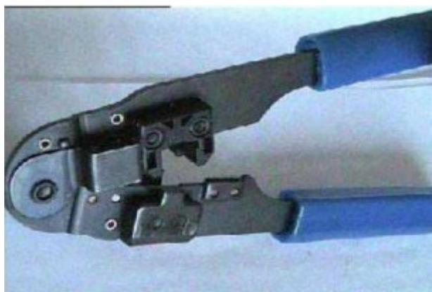
Рис. 2. Устройство для зачистки и обжима сетевого кабеля
