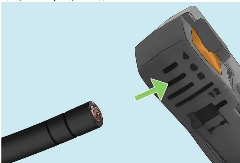
**5. Снимите внешнюю изоляцию, которая была отделена от каждого кабеля вторым надрезом стриппера.** Аккуратно потяните пальцами. Таким образом вы обнажите слой фольги на каждом кабеле.
