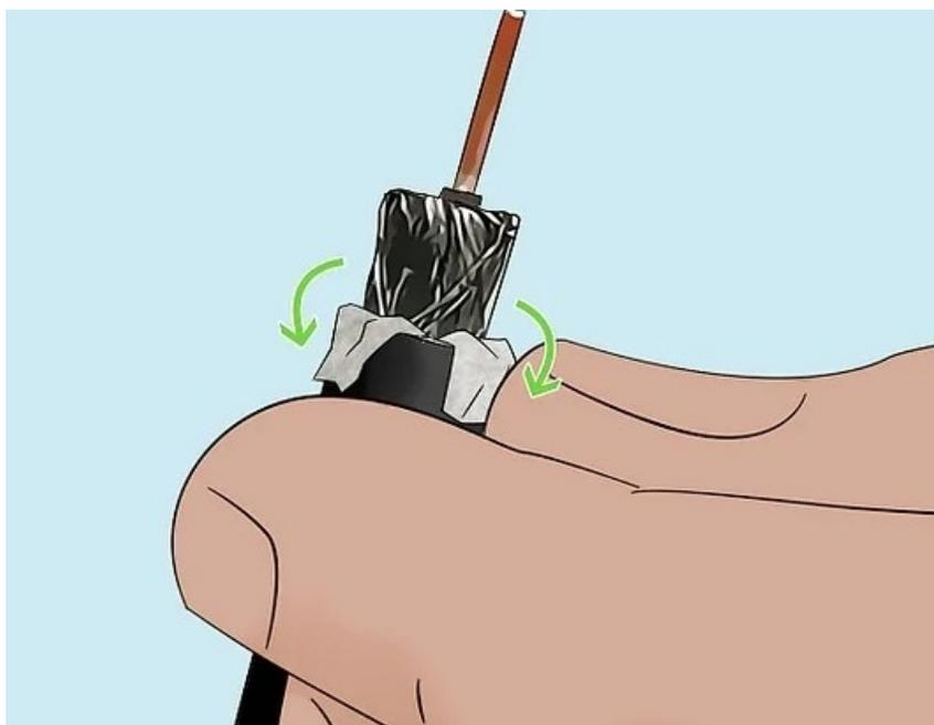
**7.Пальцами заверните металлическую сетку на каждом кабеле.** Не обрывайте фольгу под металлической сеткой. Этот слой фольги защищает внутреннюю изоляцию. Заверните металлическую сетку на концах таким образом, чтобы она проходила снаружи внешней изоляции каждого кабеля.
