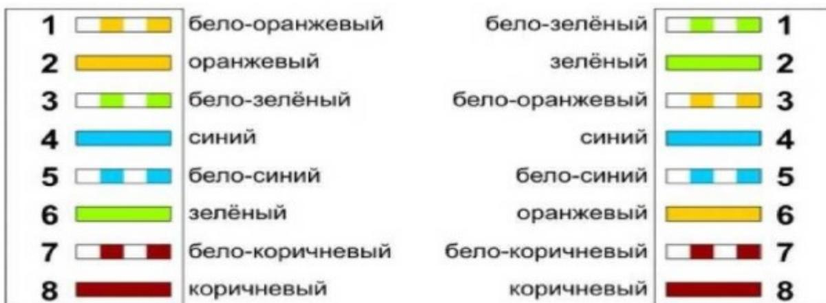
Рис. 4. Схемы обжимки кабеля: б - перекрестный (кросс-овер) кабель
