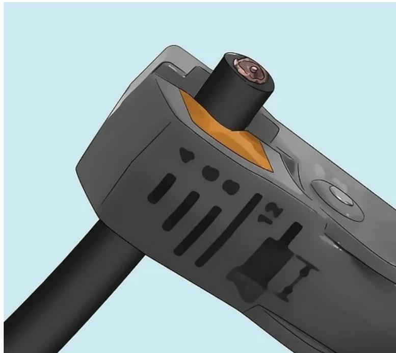
**3. Зажмите стриппер вокруг кабеля.** Как только вы зажали кабель стриппером, просто поверните стриппер 4-5 раз вокруг кабеля. Вращайте стриппер только в одном месте каждого кабеля. Не применяйте усилий, направленных на "стягивание" изоляционного покрытия кабеля.
