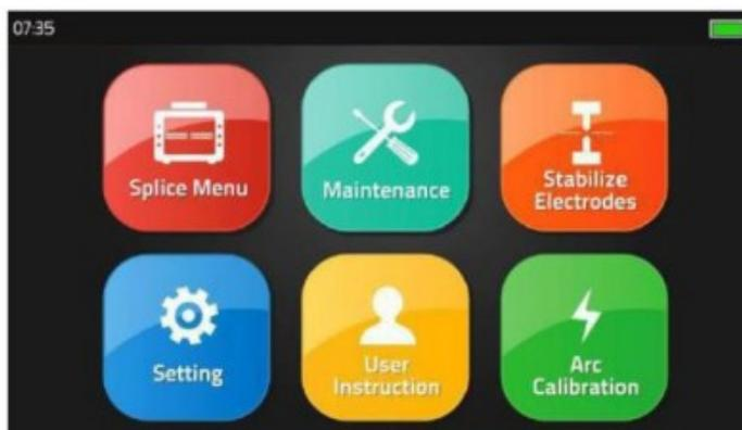
Рисунок 7 – Меню управления сварочного аппарата FiberFox Mini-4S
