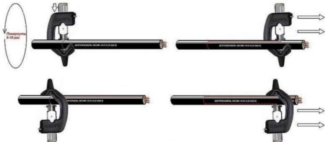
Рисунок 6 – Снятие внешней оболочки кабеля ножом-стриппером
