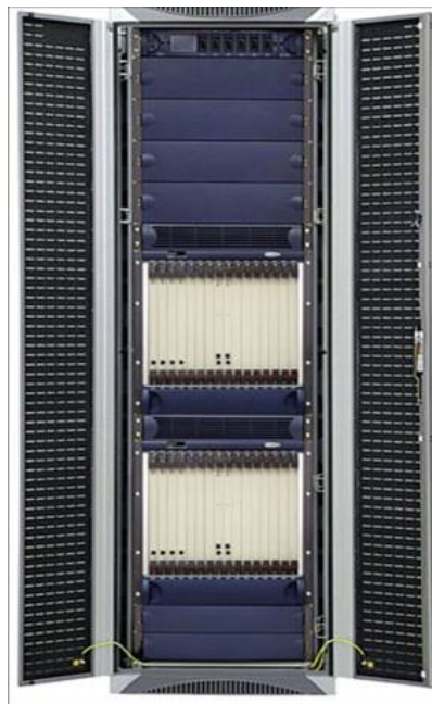
Рис.2.1. Внешний вид медиашлюза UMG8900
