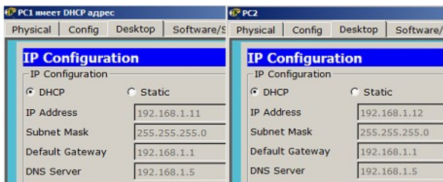
Рис. 6.28. PC1 и PC2 получают IP адреса от DHCP сервера
