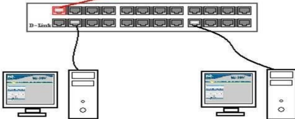
Рисунок 1 – Подключение маршрутизатора DVX-7090 к коммутатору локальной
