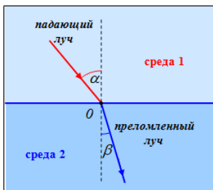
Рис. 2. Преломление света на плоской границе раздела двух прозрачных сред
