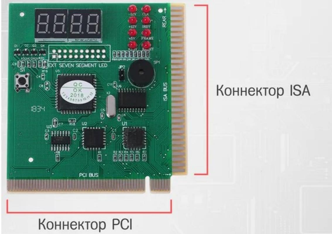
Кроме того, многие диагностические POST-карты оснащены различными светодиодами для диагностики проблем, связанных с напряжением питания, что обеспечивает комплексную среду для устранения неполадок.
