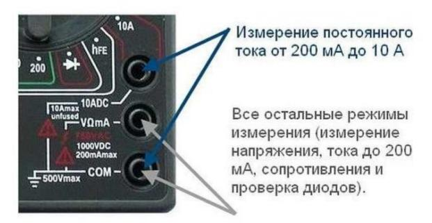
Для измерения целостности провода (перемычки) переводим переключатель в зону обозначенную буквой  $\Omega$ . Выбираем любой из диапазонов. Один шуп прикладываем к одному входу, второй — к другому. Появившиеся цифры или звуковой сигнал говорит о наличие цепи (целостности провода). Таким же образом проверяем целостность выполненных электромонтажных работ, если нет необходимости точного замера параметров.
