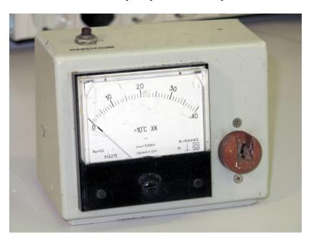
"Прибор контроля температуры паяльника" - ПКТП. Используется термопара ХК (хромель-копель), просто потому, что она выдает максимальное количество милливольт. При этом, термопара ХК имеет заметную нелинейность.
