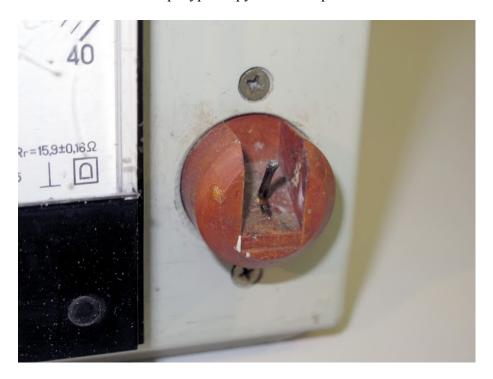
Для осуществления замера набрать в ложку жала паяльника припой, установить жало на выносной контакт термопары. После замера сделать сброс кнопкой «компенсация».
