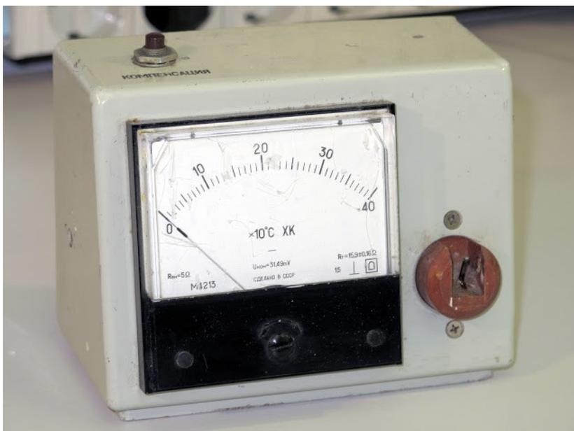
"Прибор контроля температуры паяльника" - ПКТП. Используется термопара ХК (хромель-копель), просто потому, что она выдает максимальное количество милливольт. При этом, термопара ХК имеет заметную нелинейность.
