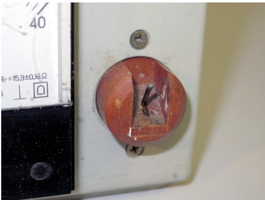
Для осуществления замера набрать в ложку жала паяльника припой, установить жало на выносной контакт термодары. После замера сделать сброс кнопкой «компенсация».
