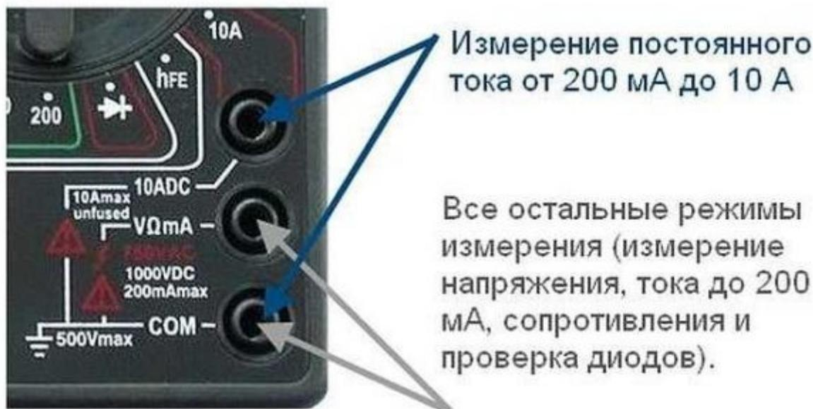
Для измерения целостности провода (перемычки) переводим переключатель в зону обозначенную буквой  $\Omega$ . Выбираем любой из диапазонов. Один щуп прикладываем к одному входу, второй — к другому. Появившиеся цифры или звуковой сигнал говорит о наличие цепи (целостности провода). Таким же образом проверяем целостность выполненных электромонтажных работ, если нет необходимости точного замера параметров.
