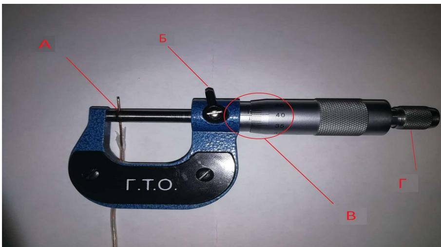
Рассмотрите пример определения сечения для одножильного провода
