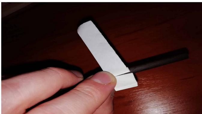
Затем бумагу прикладывают к проводу и заворачивают по окружности до соприкосновения полоски. В месте соприкосновения ее загибают второй раз и прикладывают к линейке для измерения.
