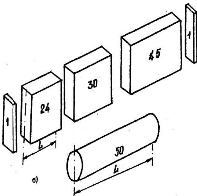
Концевые меры: а) - плоскопараллельные; б) – цилиндрические
