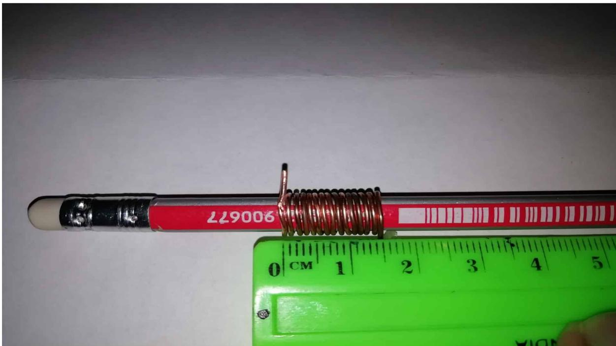
Так как все провода имеют одинаковую толщину, то для определения диаметра медных проводов, измерьте длину всей намотки и разделите на количество витков. В данном примере  $D = 15 \text{ мм} / 15 \text{ витков} = 1 \text{ мм}$ , соответственно, используя ту же формулу расчета, получим сечение  $S = 3,14 \times 1 \times 1 / 4 = 0,78 \text{ мм}^2$ . Заметьте, чем больше витков вы сделаете, тем более точно определите сечение.
