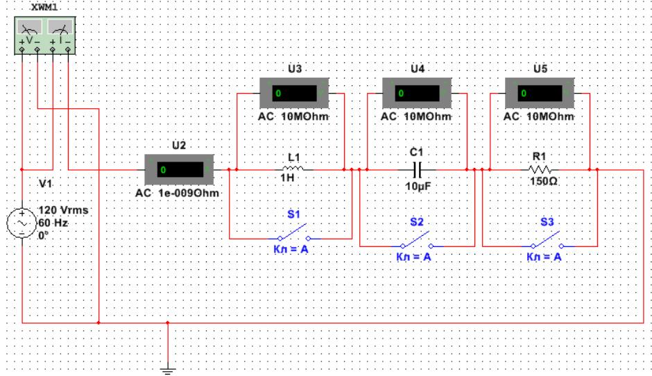
4. Манипулируя переключателями создать режимы для измерения параметров, результаты измерений и расчетов занести в таблицу. По результатам измерений построить векторную диаграмму.
