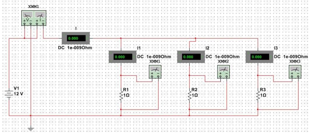
Рисунок 1 – Схема исследования
