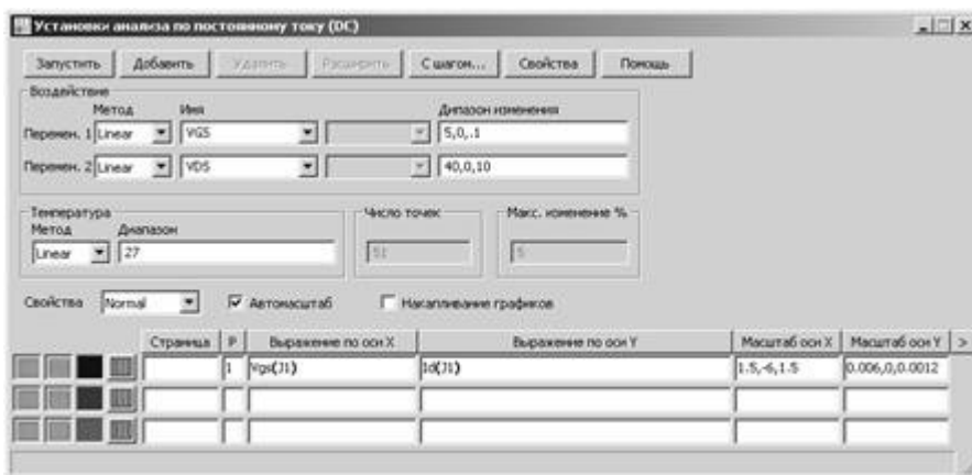
Рис. 3.6 Окно установок анализа по постоянному току для снятия сток - затворной статической характеристики
