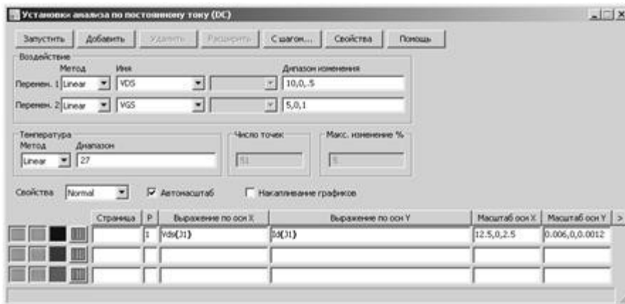
Рис. 3.7 Окно установок анализа по постоянному току для снятия стоковой статической характеристики
