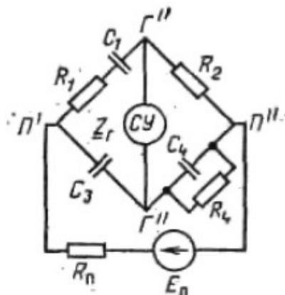
4. На рисунке представлена уравновешенная мостовая цепь. Потери в конденсаторе  $C_1$  учитываются сопротивлением  $R_1$ . Известно, что  $R_2=100$  Ом,  $R_4=1000$  Ом,  $C_3=0,05$  мкФ,  $C_4=0,1$  мкФ, мост питается переменным
