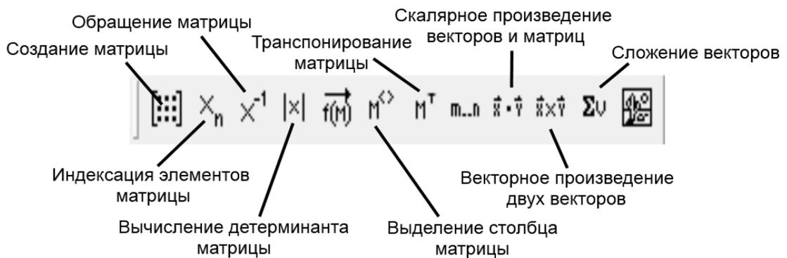
Рис. 19. Инструменты панели инструментов «Вектор и матрица (Matrix)»
