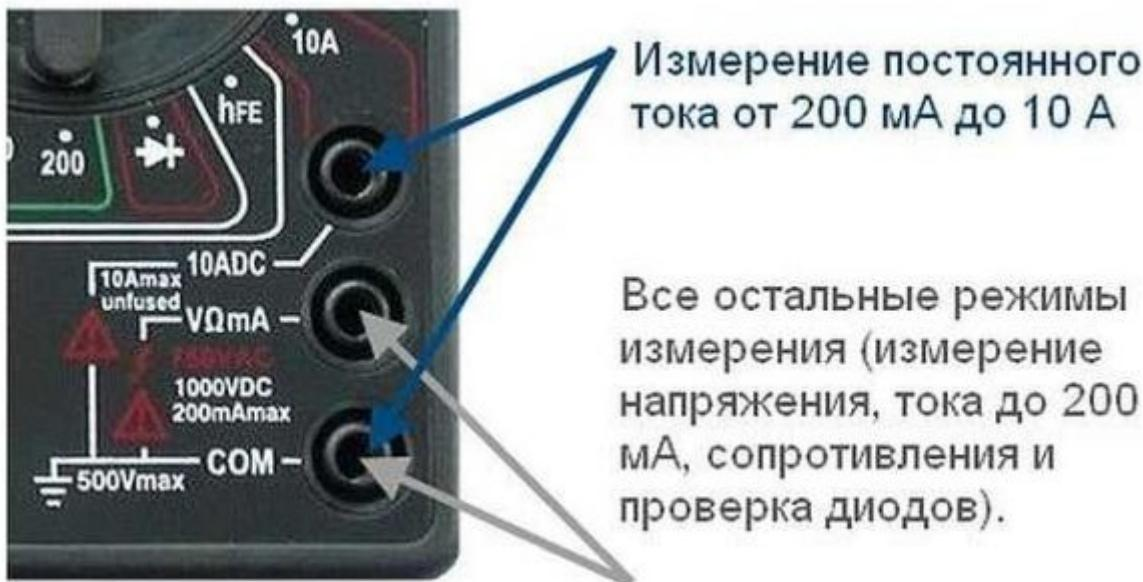
Для измерения целостности провода (перемычки) переводим переключатель в зону обозначенную буквой  $\Omega$ . Выбираем любой из диапазонов. Один щуп прикладываем к одному входу, второй — к другому. Появившиеся цифры или звуковой сигнал говорит о наличие цепи (целостности провода). Таким же образом проверяем целостность выполненных электромонтажных работ, если нет необходимости точного замера параметров.
