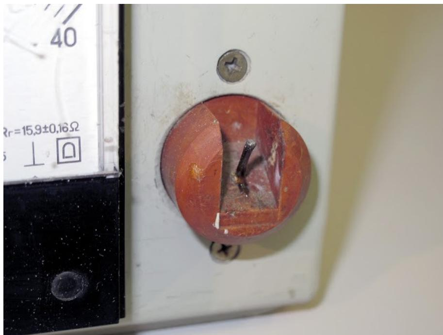
Для осуществления замера набрать в ложку жала паяльника припой, установить жало на выносной контакт термопары. После замера сделать сброс кнопкой «компенсация».
