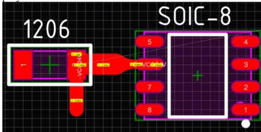
Стоит понимать, что данный вариант является идеальным и трудно реализуемым при реальном изготовлении платы. В этом случае переход толщины проводника не выполняют, а принимают ширину дорожки относительно минимальной площадки
