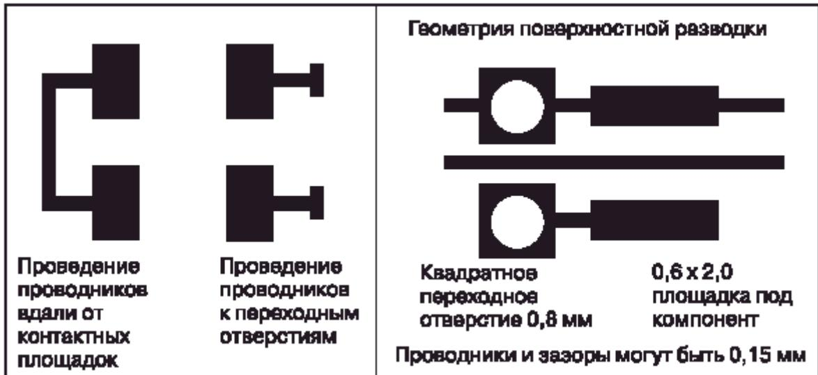
Чрезмерно близкое размещение контактных площадок и переходных отверстий препятствует уходу тепла и припоя с контактной площадки, и как следствие — «холодная» пайка. В этом случае справедливы те же рекомендации, что и для широких проводников. На рисунке представлено рекомендуемое расположение переходных отверстий и контактных площадок на печатной плате.
