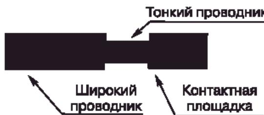
Ширина подводящего «узкого» проводника может варьироваться в пределах от 0,25 до 0,125 мм (зависит от технологических возможностей производителя печатных плат).
