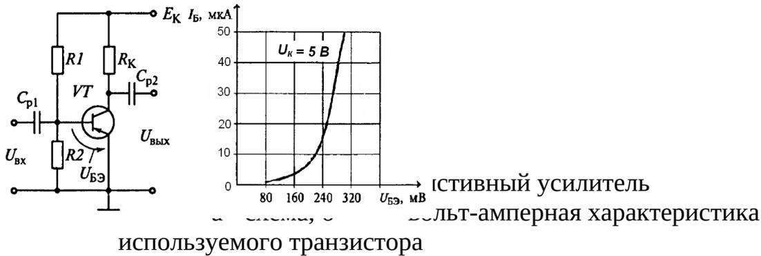
На рисунке приведена схема резистивного усилителя (а) и входная характеристика используемого транзистора (б).
