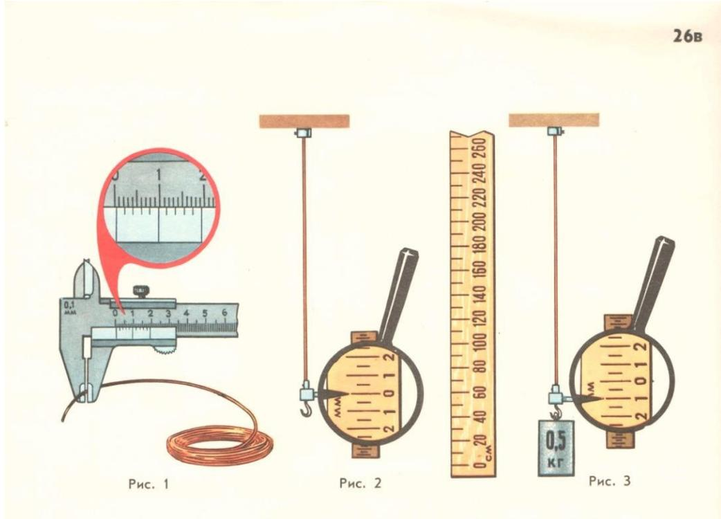
**Задание** (карта 26В): От мотка провода (рис.1) отрезали некоторую часть и укрепили между зажимами А и В следовательно устройства (рис.2). Нижний зажим В этого устройства имеет указатель (стрелку), который перемещается по шкале. На нижний зажим повесили гирю (рис.3). Определите напряжение в медной проволоке и модуль Юнга, если элементы каждого рисунка представлены в одном и том же масштабе.
