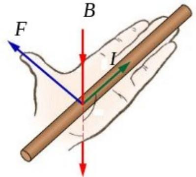
правила левой руки: расположим левую руку так, чтобы магнитные силовые линии входили в ладонь, четыре пальца левой руки нужно ориентировать в направлении тока, а отогнутый на  $90^\circ$  большой палец левой руки будет направлен вдоль силы Ампера, действующей на проводник с током. Силы  $F_2$  и  $F_4$  равны по модулю и противоположны
