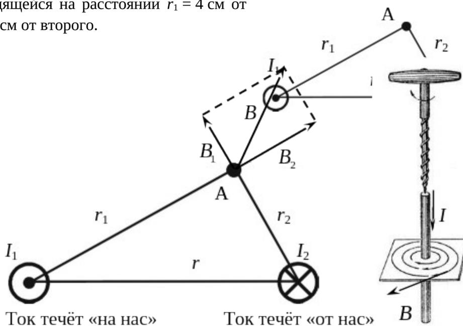
Длинный прямой провод, по которому протекает ток  $I$ , создаёт вокруг себя магнитное поле на расстоянии  $R$  индукцией:
