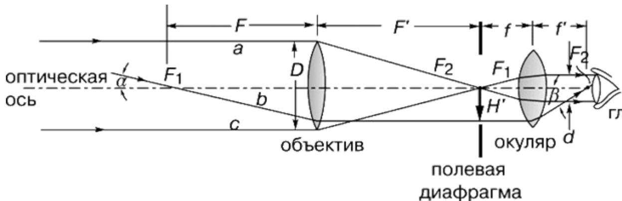
Телескоп принято характеризовать угловым увеличением  $\gamma$ . В отличие от микроскопа, предметы, наблюдаемые в телескоп, всегда удалены от наблюдателя.
