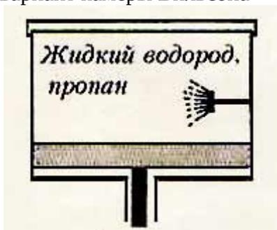
При резком понижении поршня жидкость, находящаяся под высоким давлением, переходит в перегретое состояние. При быстром движении частицы по следу образуются пузырьки пара, т.е. жидкость закипает, виден трек.
