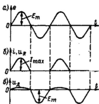
Графики на рисунке 2. наглядно иллюстрируют процессы в выпрямителе. Переменная ЭДС генератора изображена синусоидой с амплитудой  $E_m$  (рисунок 2, а). Как правило, сопротивление нагрузки во много раз больше сопротивления диода, и тогда нелинейностью диода можно пренебречь (рабочая характеристика близка к линейной). В этом случае выпрямленный ток имеет форму импульсов, близкую к полусинусоиде с максимальным значением  $I_{max}$  (рисунок 2.20, б). Этот
