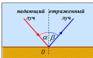
**Отражение света** — это изменение направления световой волны при падении на границу раздела двух сред, в результате чего волна продолжает распространяться в первой среде. Направления распространения падающей и отраженной волн показаны на рис. 1
