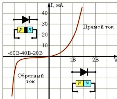
**Текст 1.** Здесь показано условное графическое обозначение выпрямительного диода (в). Вершина треугольника «стрелка» показывает направление прямого тока протекающего от большого потенциала «+» (анода) к меньшему потенциалу «-» (катоду).
